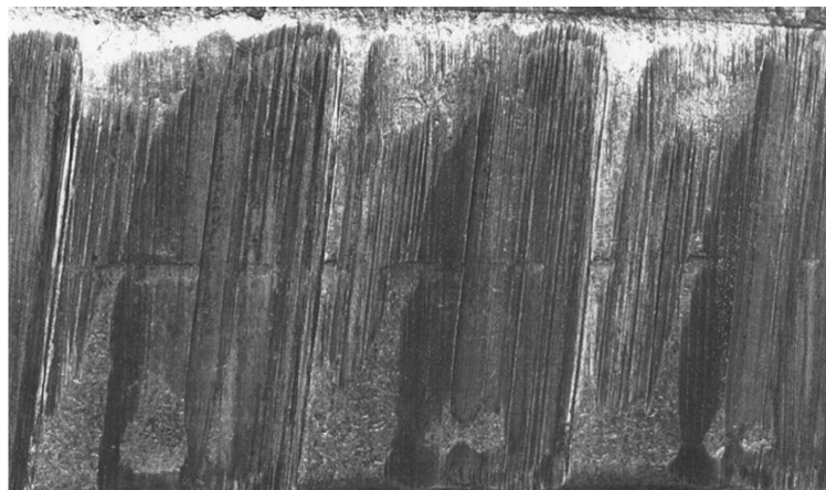
Obrázok č. 3: Zošínuté stopy polí vývrtnu hlavne na plášti strely, zdroj: archív autora.
